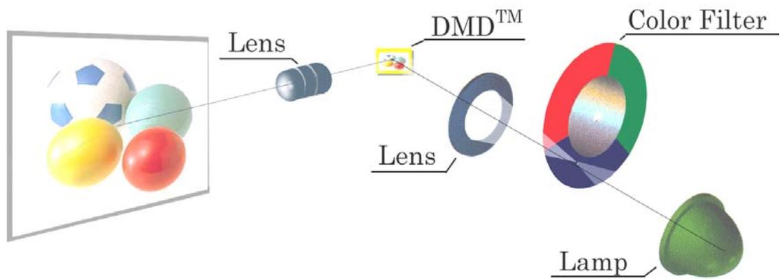
Отклонившееся зеркало направляет поступающий свет в объектив, а затем на экран. В стационарном состоянии отраженный от зеркала свет направляется в световой поглотитель.
